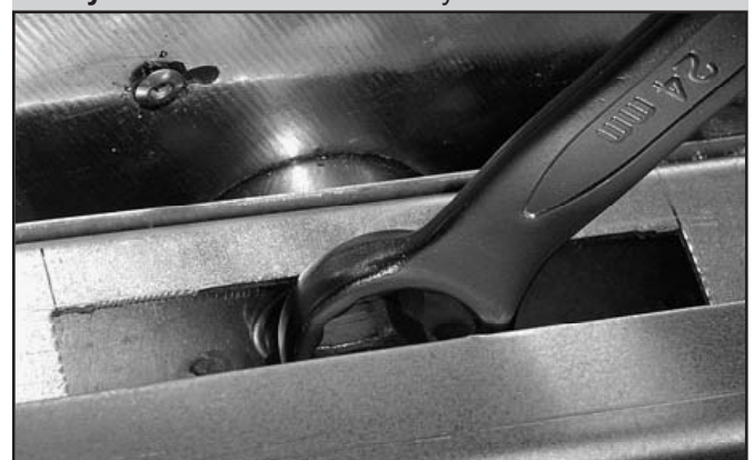
Рисунок 8 – Осевой болт отпустить ключом №24
